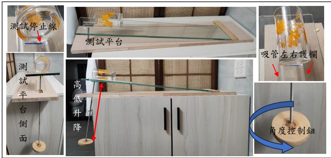
圖 5 杯套摩擦效能實驗設備解說圖
